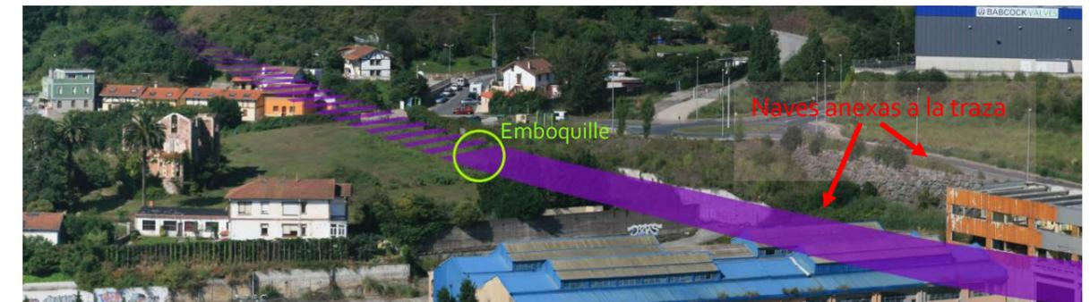
En este punto da inicio un largo trazado excavado en mina que se inicia con una sección de vía doble que se prolonga a lo largo de algo más de 900 metros, evitando el cruce bajo la galería de extracción minera
