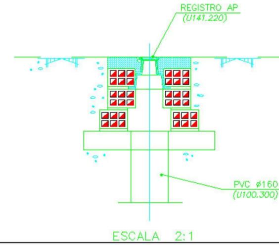
FIGURA 3: Detalle de instalación registro tipo AP.
