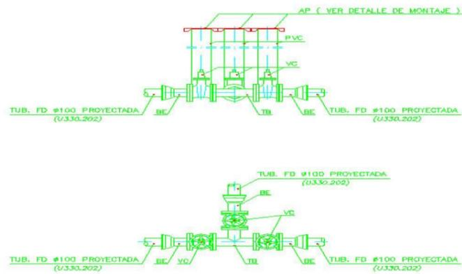
FIGURA 2: Detalle de tipo de conexión en "T"
