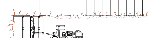
V. SOSTENIMIENTO MEDIANTE CERCHAS LIGERAS Y BULONES TIPO SWELLEX DE 150 KN
