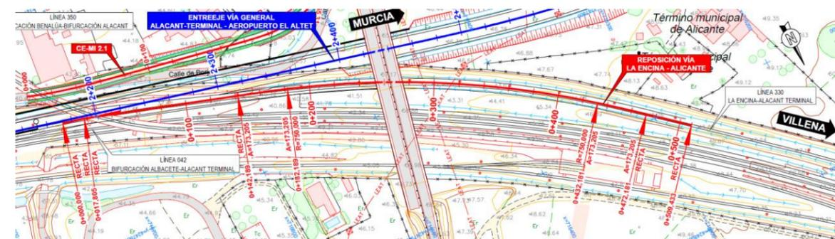
Como se puede apreciar, la reposición de la línea La Encina – Alacant Terminal, deberá corregir su trazado ligeramente para conectar mediante un aparato de desvío a la vía derecha del corredor Alacant-Terminal – Aeropuerto El Altet, que permitirá el acceso de la línea existente a la estación de Alcant-Terminal a través el canal de acceso soterrado.
