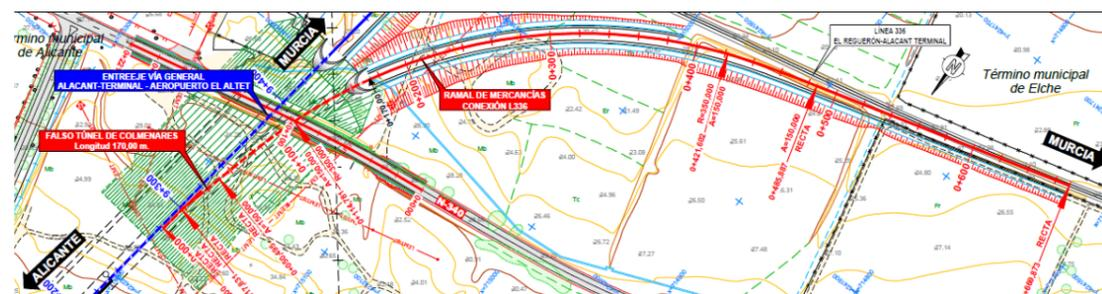
Al tratarse de un ramal de mercancías en variante a la línea 336, como situación provisional únicamente será considerada la conexión mediante aparato de desvío de nuevo ramal con la línea existente, trabajos que deberán abordarse en banda de mantenimiento, puesto que la instalación del aparato de desvío no es compatible con las circulaciones ferroviarias existentes.
