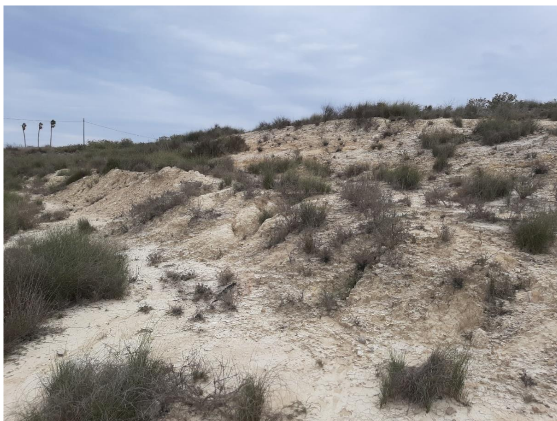
Ilustración 20. Unidad T MG en la base de la sucesión estratigráfica terciaria, aflorando margas grises (P.K. 7+400)
