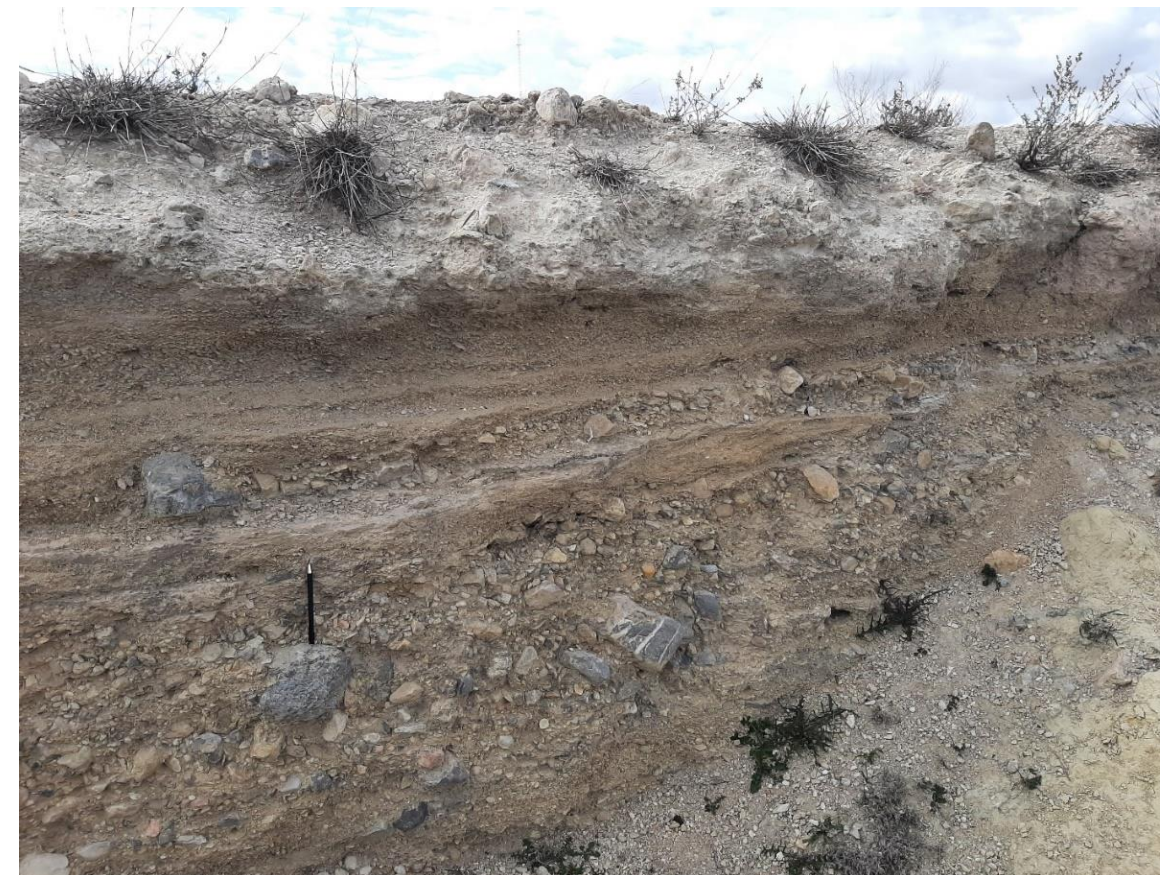
Ilustración 23. Laminaciones paralelas en la unidad Q_{TS} , en el P.K. 6+100 de la Alternativa de actuación. presencia de bolos procedentes de la sierra de Fontcalent.
