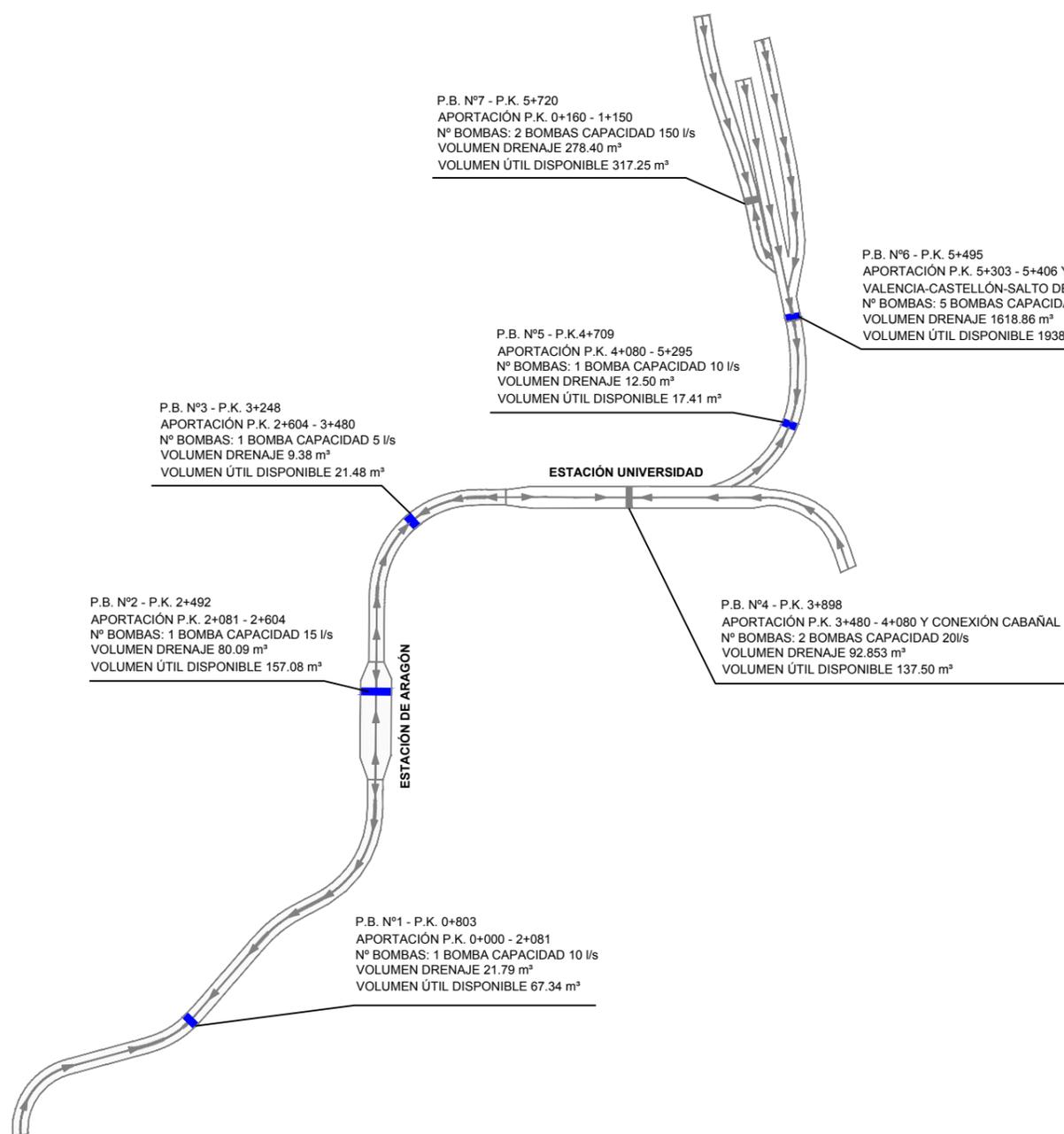
ESQUEMA DE PRINCIPIO DE DRENAJE Y BOMBEO. MODO FUNCIONAMIENTO NORMAL
