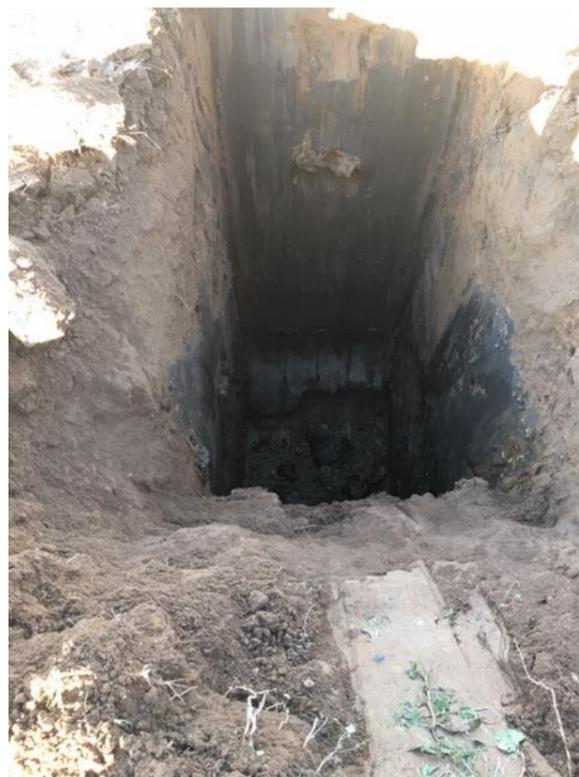
Figura 72. Detalle calicatas (arcillas orgánicas inferiores)
