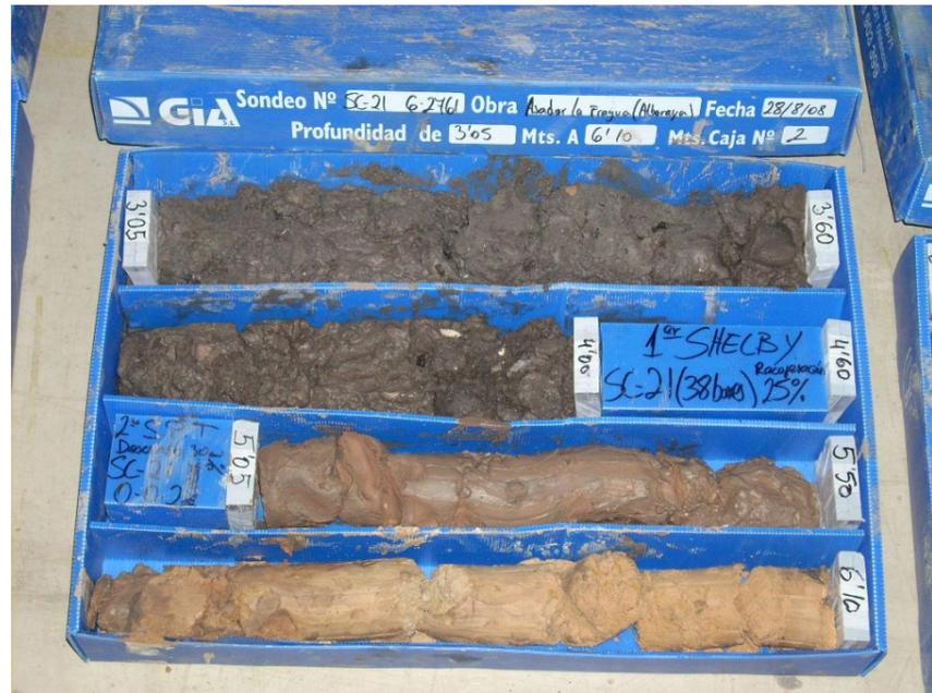
Figura 11. Detalle arcillas limosas superiores grisáceas (nivel A0)
