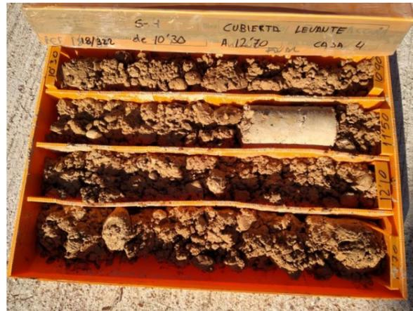
Figura 24. Detalle nivel de gravas-ampliación Ciutat Valencia
