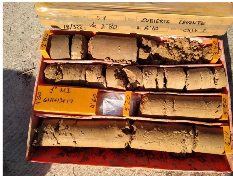
**Figura 22. Detalle arcillas limosas inferiores medias-firmes (nivel A1)**
