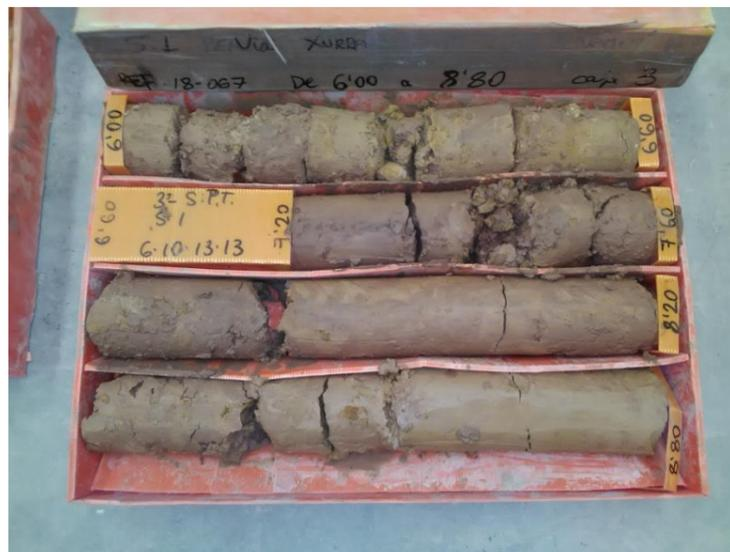
Figura 47. Detalle arcillas limosas (A1) superficiales salida Vinalesa
