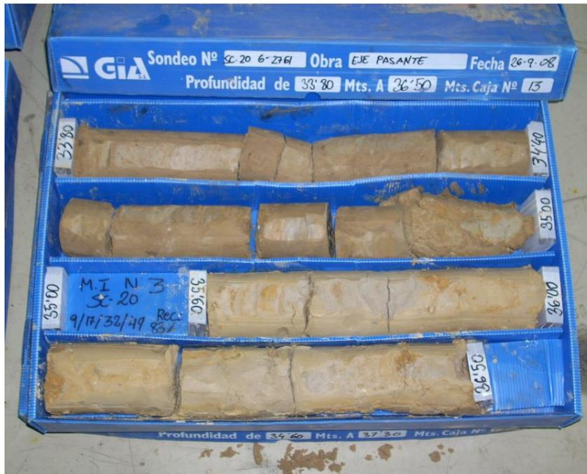
Figura 20. Detalle arcillas limosas inferiores firmes (nivel A2-A3)
