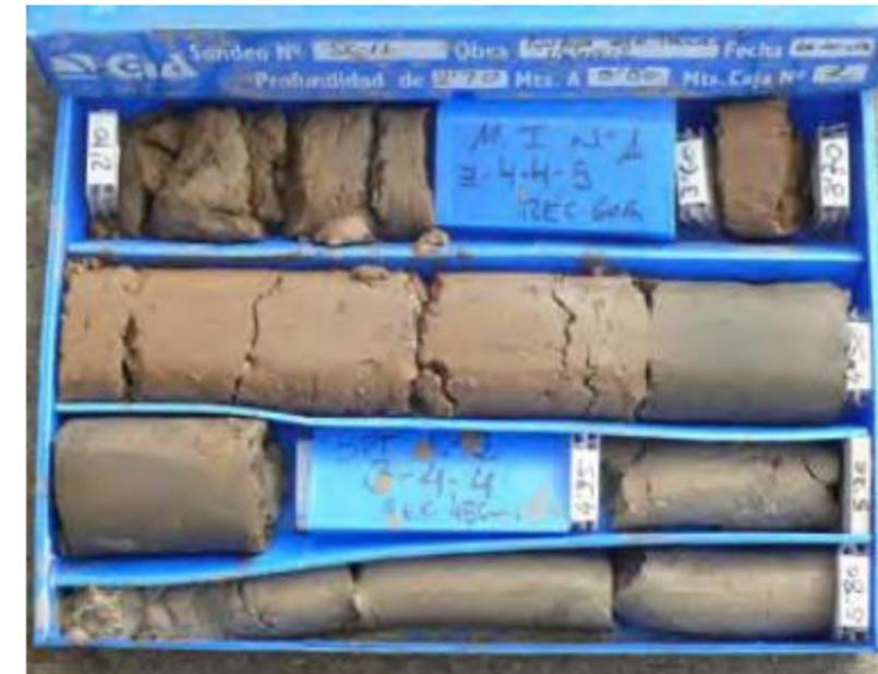
Figura 13. Detalle arcillas limosas superiores (nivel A1)
