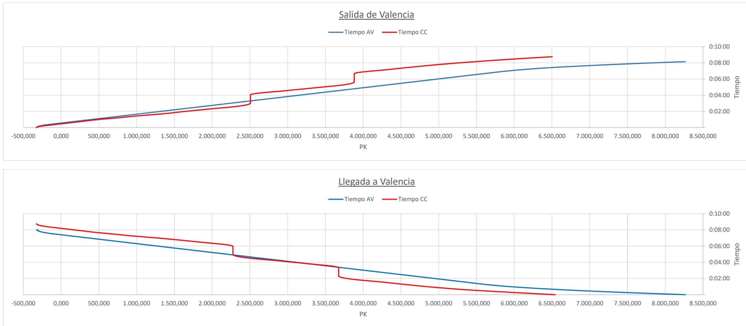
Figura 8: Diagrama de tiempos de recorrido en el tramo. Alternativa Base. La línea roja muestra la velocidad de los trenes de cercanías y la azul la de los trenes AV. Fuente: elaboración propia.
