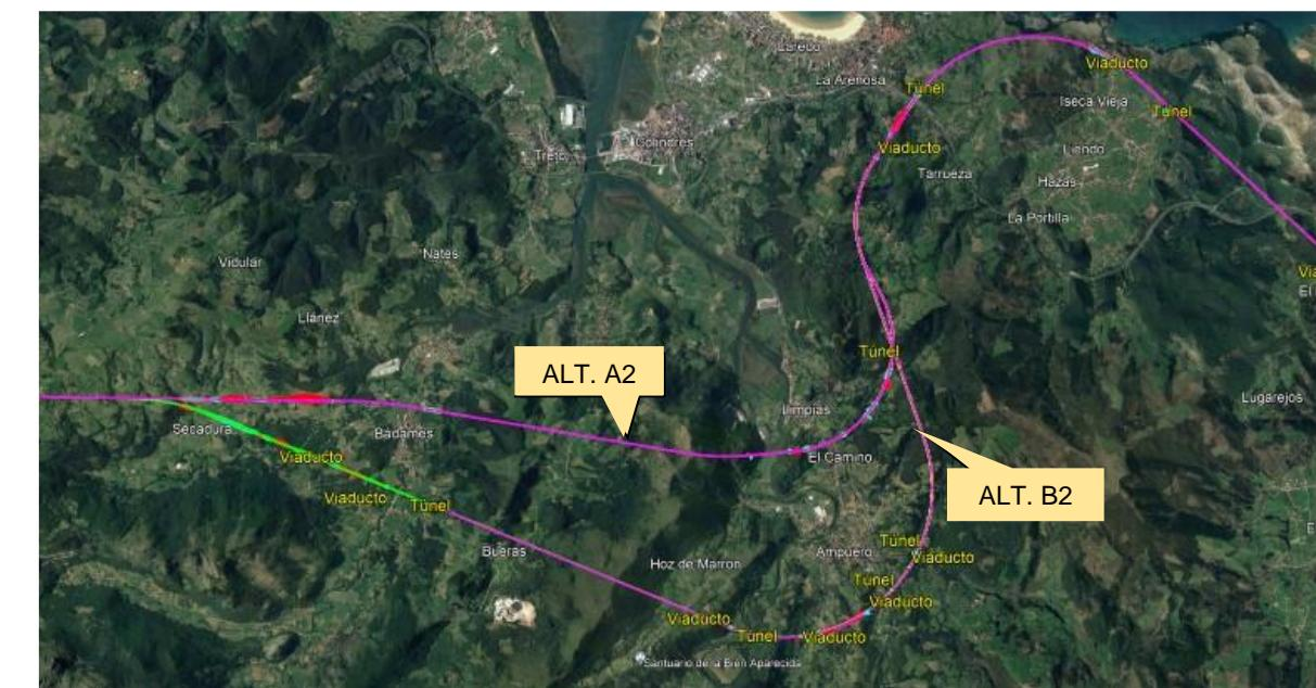
Figura 38. Trazado en planta Alternativa B2. Trazado no coincidente con Alternativa A2
