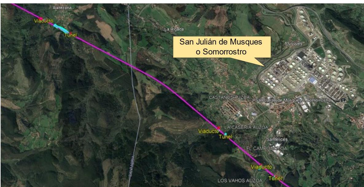
Figura 18. Trazado en planta Alternativa A1 en el entorno de San Julián de Musques o Somorrostro
