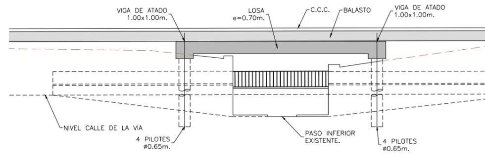
ALZADO SECCIÓN LONGITUDINAL ESTRUCTURA E-2
