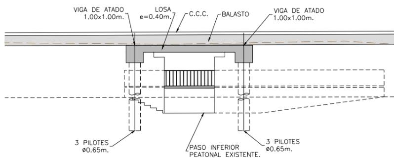
ALZADO SECCIÓN LONGITUDINAL ESTRUCTURA E-1
