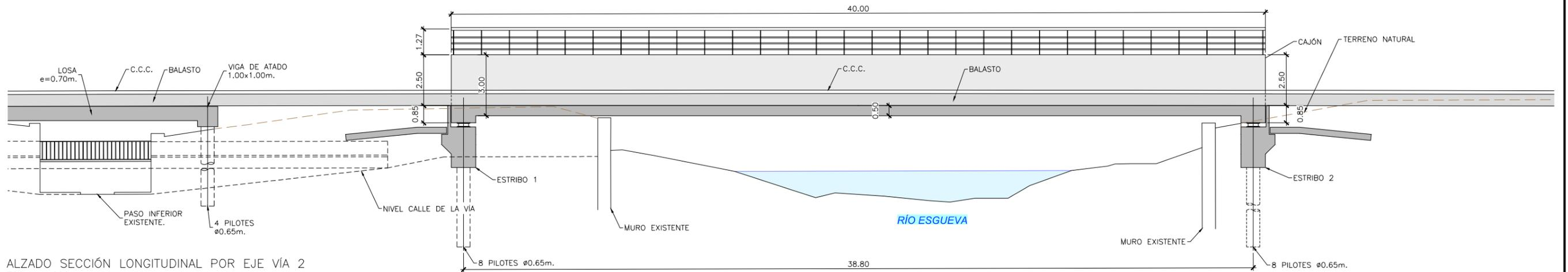
ALZADO SECCIÓN LONGITUDINAL POR EJE VÍA 2
