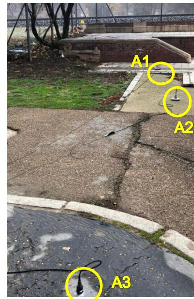
Configuración de acelerómetros en el Punto 7
