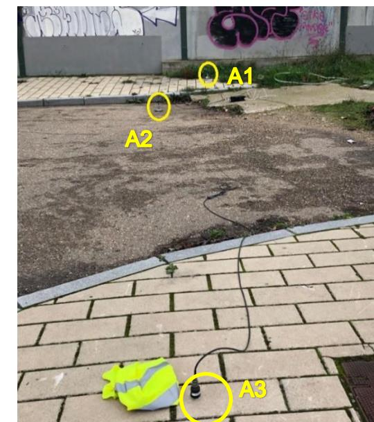
Configuración de acelerómetros en el Punto 7
