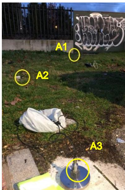
*Configuración de acelerómetros en el Punto 3*
