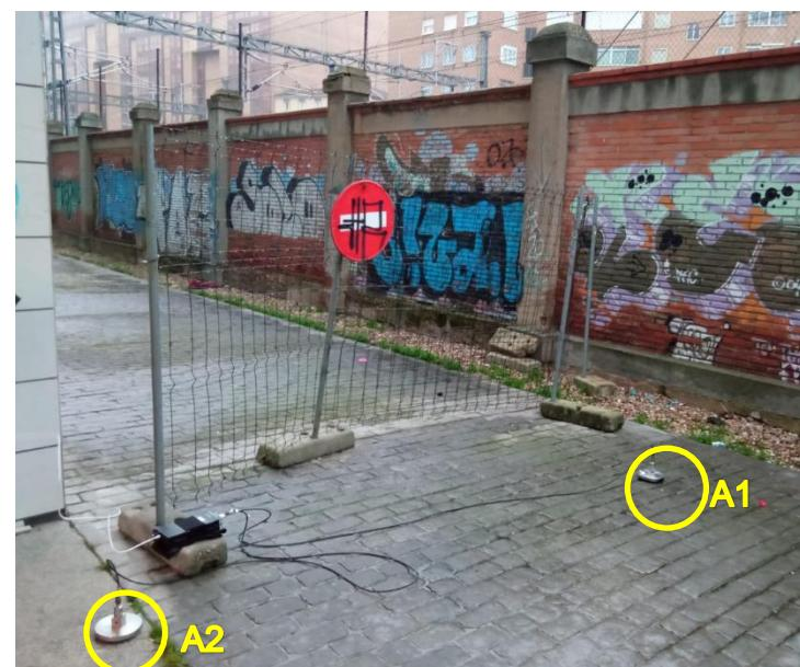
Configuración de acelerómetros en el Punto 6
