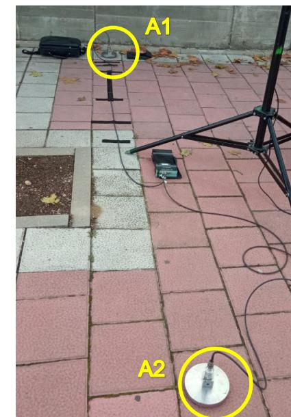
Configuración de acelerómetros en el Punto 1
