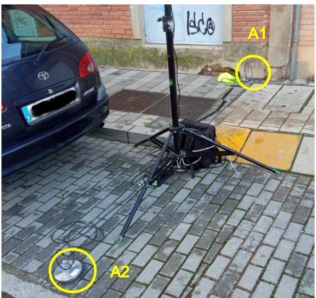
*Configuración de acelerómetros en el Punto 3*
