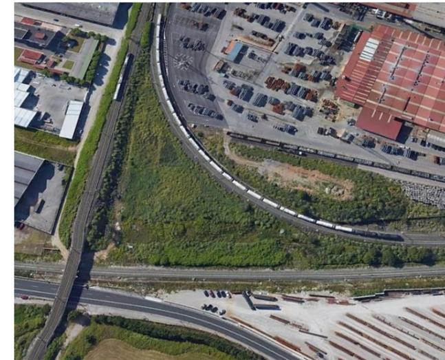
A la vista de las anteriores imágenes, se observa que la conexión de las líneas de ancho métrico mediante un paso superior sobre la calle y el ffcc de ancho ibérico es una solución técnicamente simple, y de poca afección al entorno, ya que la longitud de la misma es reducida, en planta no hay ningún condicionante importante, y en alzado las rasantes de las cuatro infraestructuras citadas favorecen esta solución.
