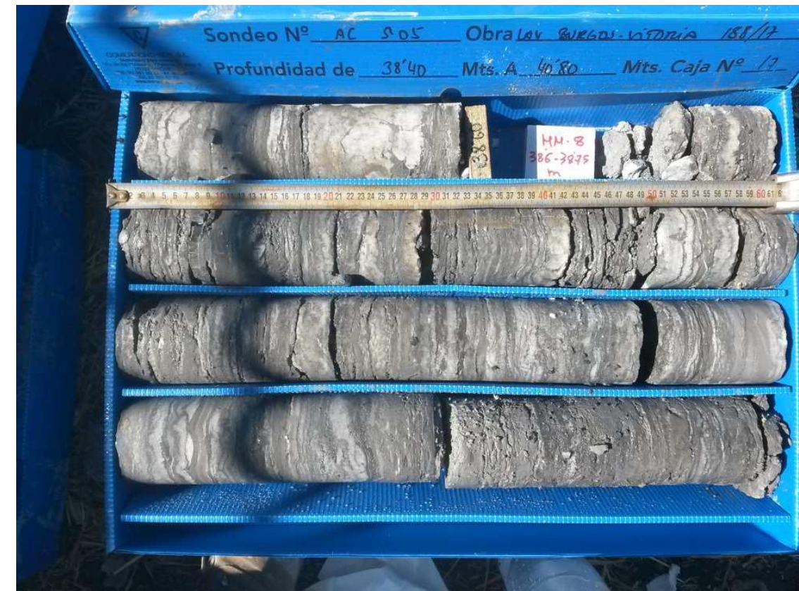
Figura 6. Aspecto de las lutitas y margas yesíferas de la F. Cerezo a cota de túnel. Sondeo ACS05. Fuente: INECO 2017.
