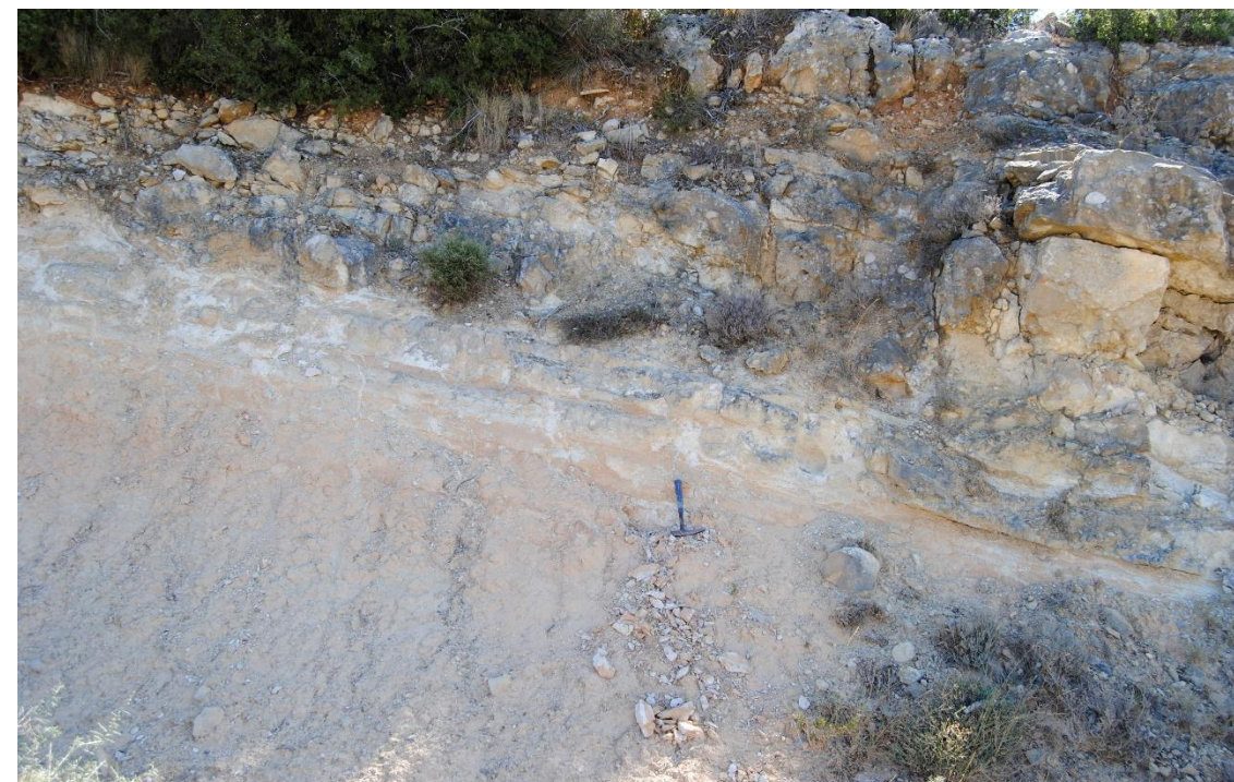
Figura 17. Aspecto de campo de las limolitas rosadas (debajo) y las areniscas y conglomerados de la unidad T7 Fuente: INECO 2017.
