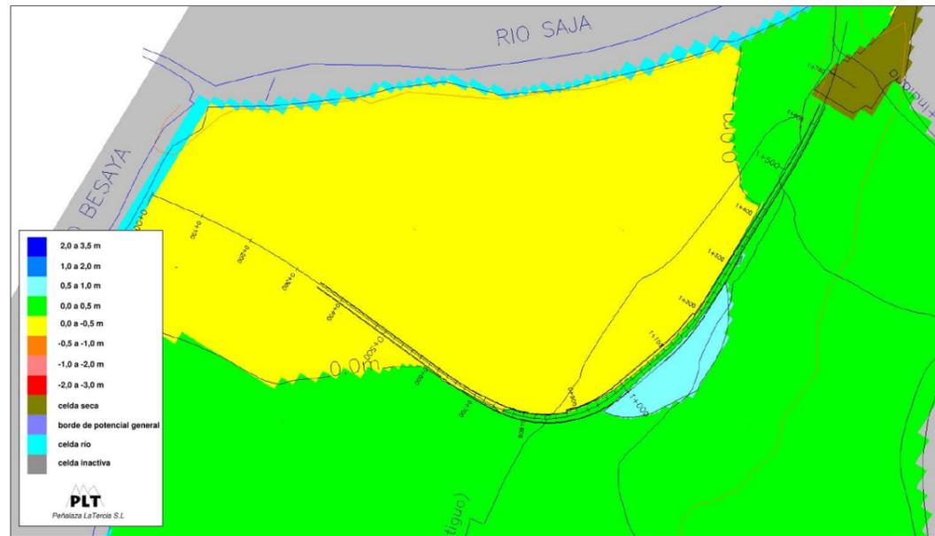
Plano de isoascensos resultante de simular una restitución del 20 % de la sección libre inicial del flujo entre los pp.kk. 0+840 y 1+300 a través de la **Alternativa Bombeos** - "hipótesis húmeda".
