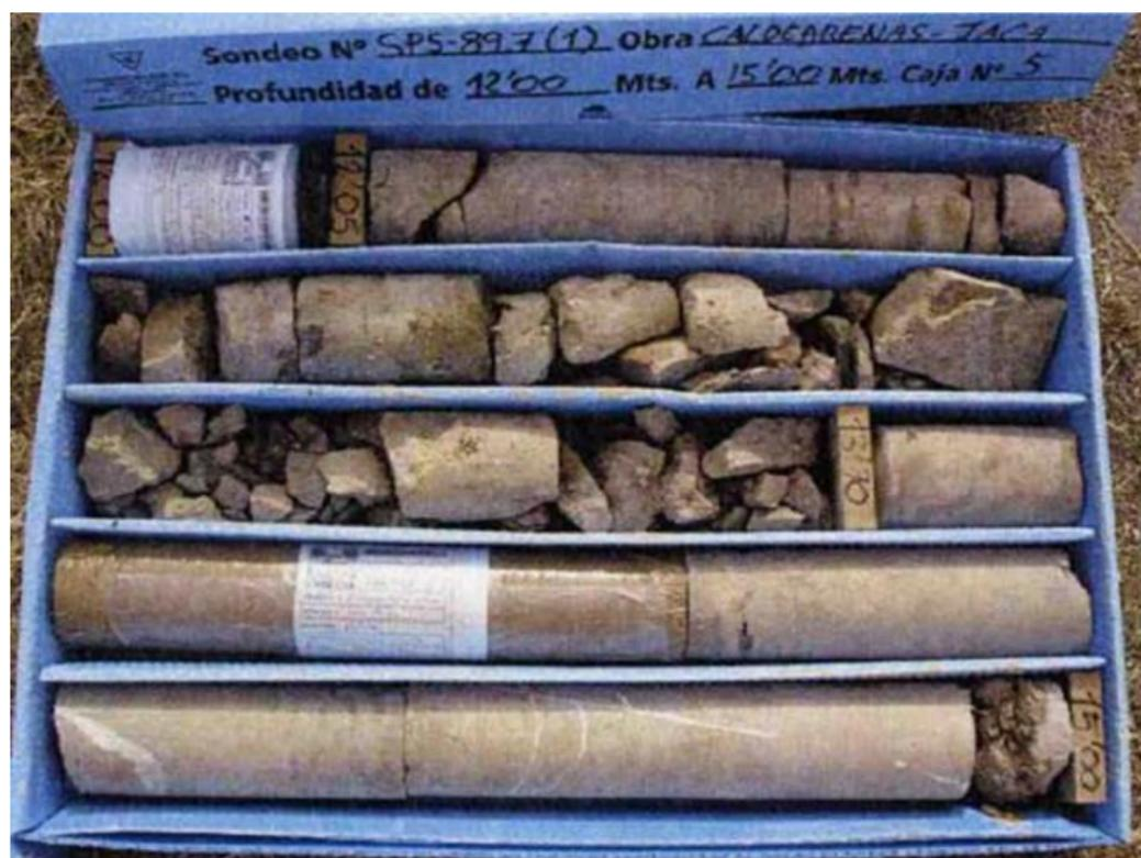
Figura 16 - Testigos de la unidad T14 atravesada por el túnel Las Lanás, procedente del SPS-89.7 (1) (fuente: PC línea Huesca – Canfranc. Tramo: Caldearenas – Jaca. Supresión de pasos a nivel, 2006)
