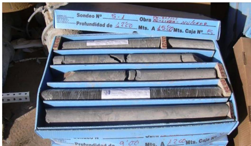
Figura 12 - Materiales de la unidad T15 atravesada por el túnel Lecinar (fuente: PC línea Huesca – Canfranc. Tramo: Ayerbe – Caldearenas. Plataforma y vía)
