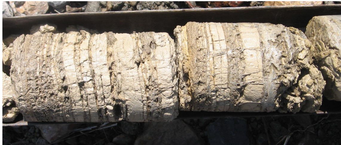
Calizas laminadas con alternancias de coloración y geodas centimétricas selladas por calcita cristalina en el Cerro de Santa Catalina.
