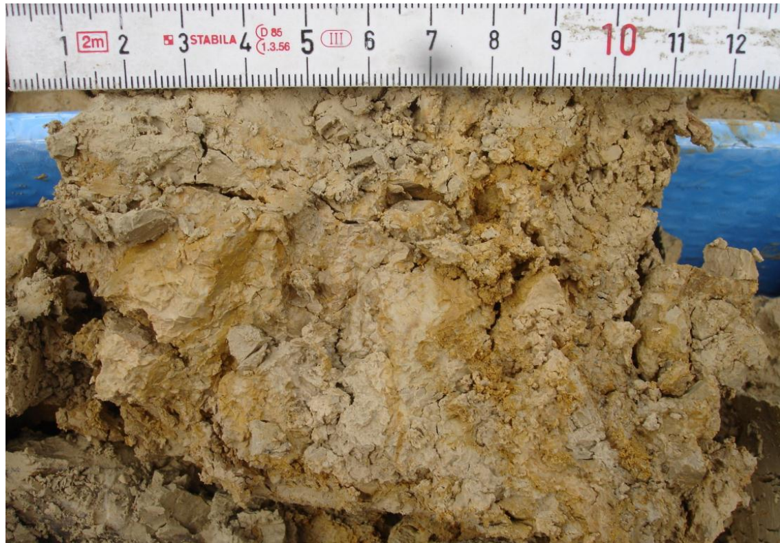
Fragmento de testigo de arcillas y limos eluviales con fragmentos angulosos de dolomía ocre
