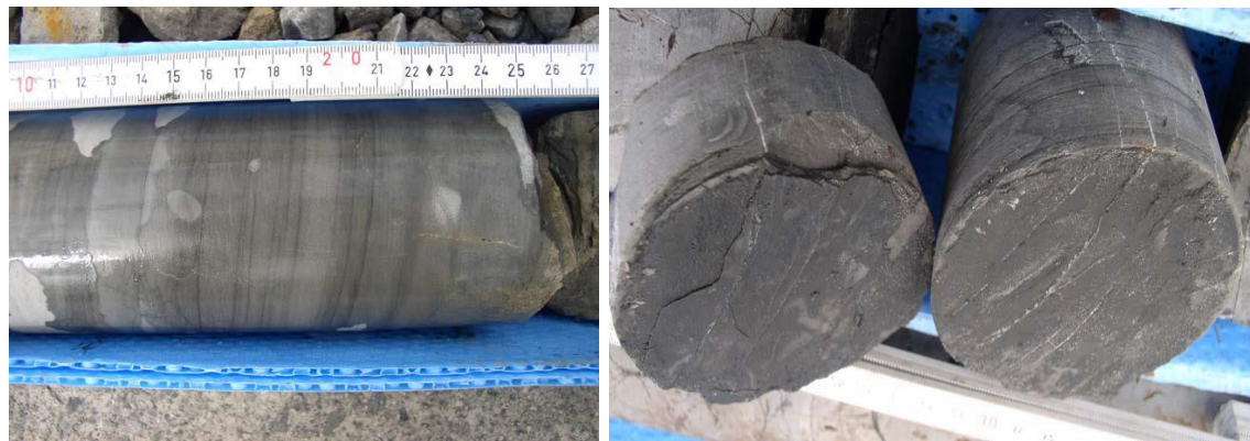
Fragmento de testigo de dolomía con laminación milimétrica buzando 10° rellena de lutita gris, intersectada por pequeñas juntas milimétricas subverticales selladas por calcita.
