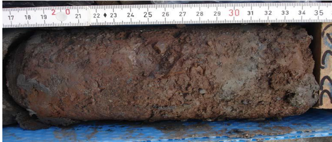
Fragmento de testigo de lutitas margosas rojizas a grises
