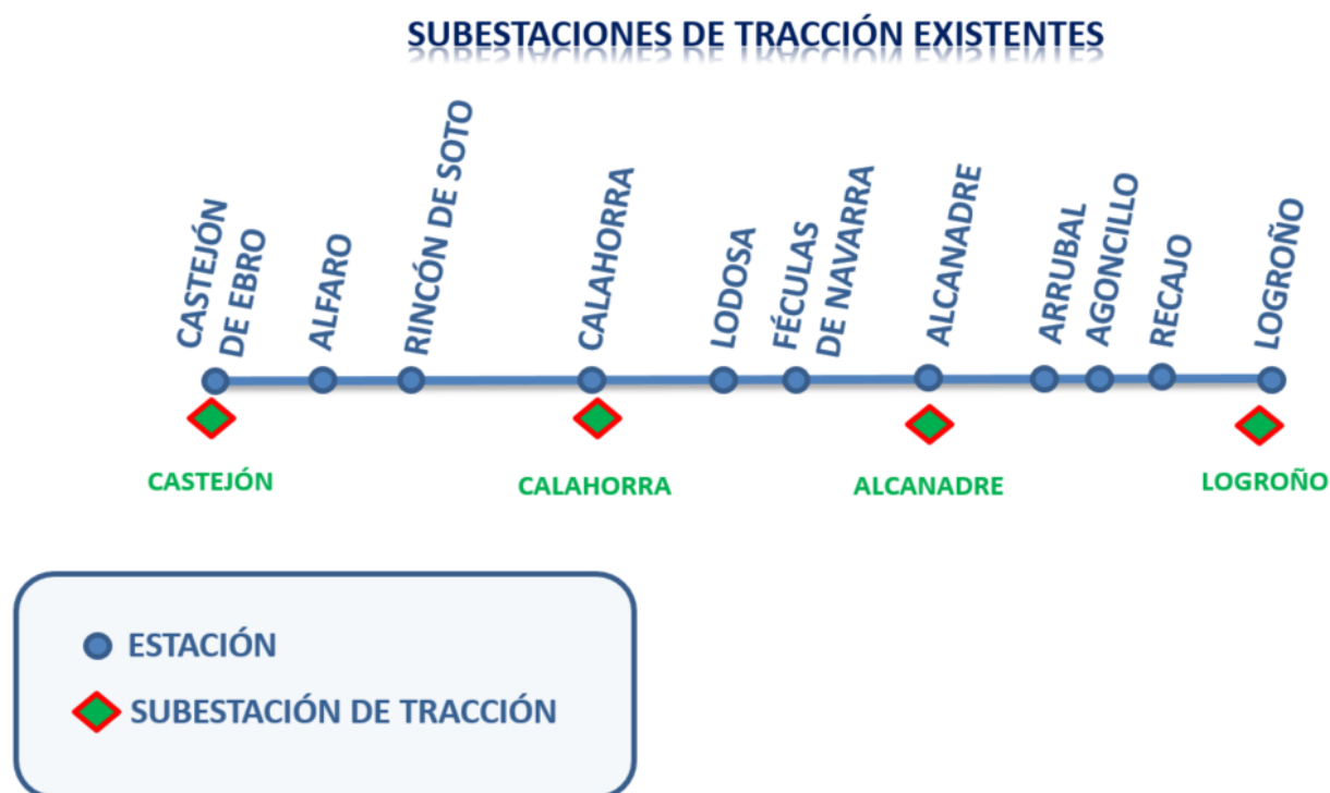
Imagen 1. Subestaciones de tracción existentes
