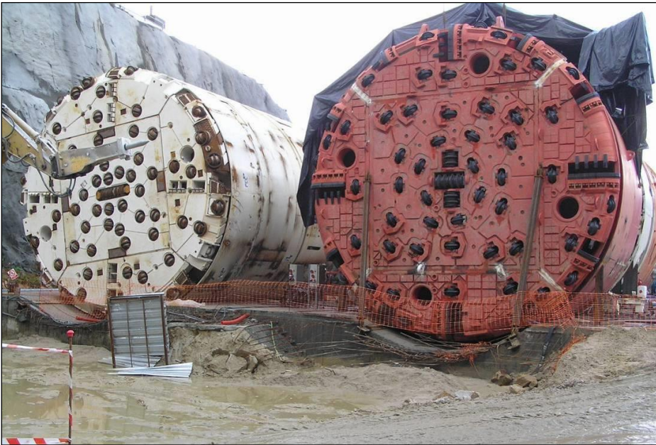
Foto 7.1. Tuneladoras para tubos gemelos para ejecución Método TBM+D
