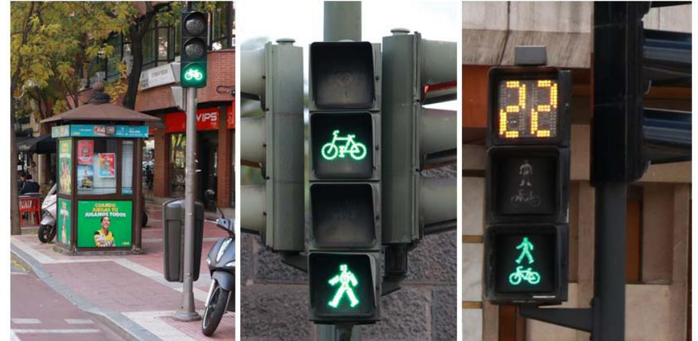
Si el paso peatonal y ciclista coinciden y sus fases están sincronizadas, se pueden combinar la silueta del peatón y de la bici en una misma lámpara para no duplicar los elementos de la cabeza del semáforo. En general, sin embargo, se recomienda disponer de sistemas semaforicos independientes que faciliten una regulación diferente, si fuese necesario, y no envíen a la ciudadanía el mensaje erróneo de que movilidad ciclista y peatonal son lo mismo.
