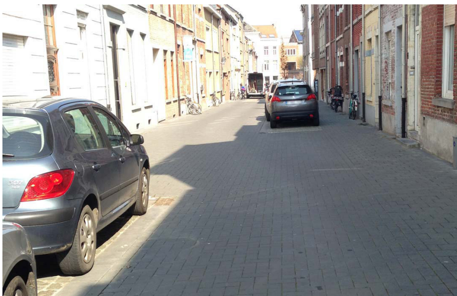
Fotografía 5.36 Zigzag mediante disposición alterna del aparcamiento
