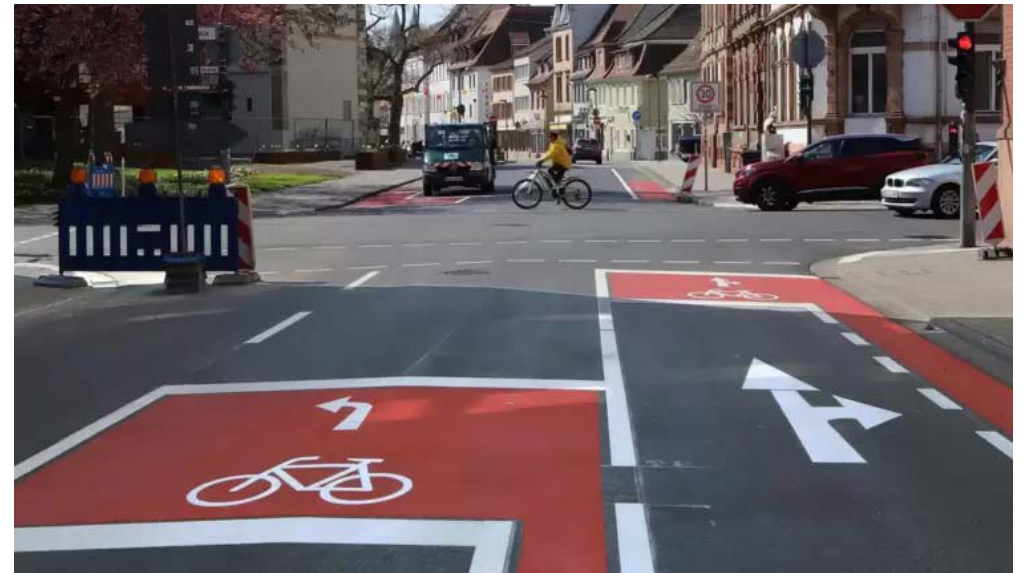
Fotografía 5.10 Plataformas avanzadas de espera y carriles ciclistas complementarios de acceso
