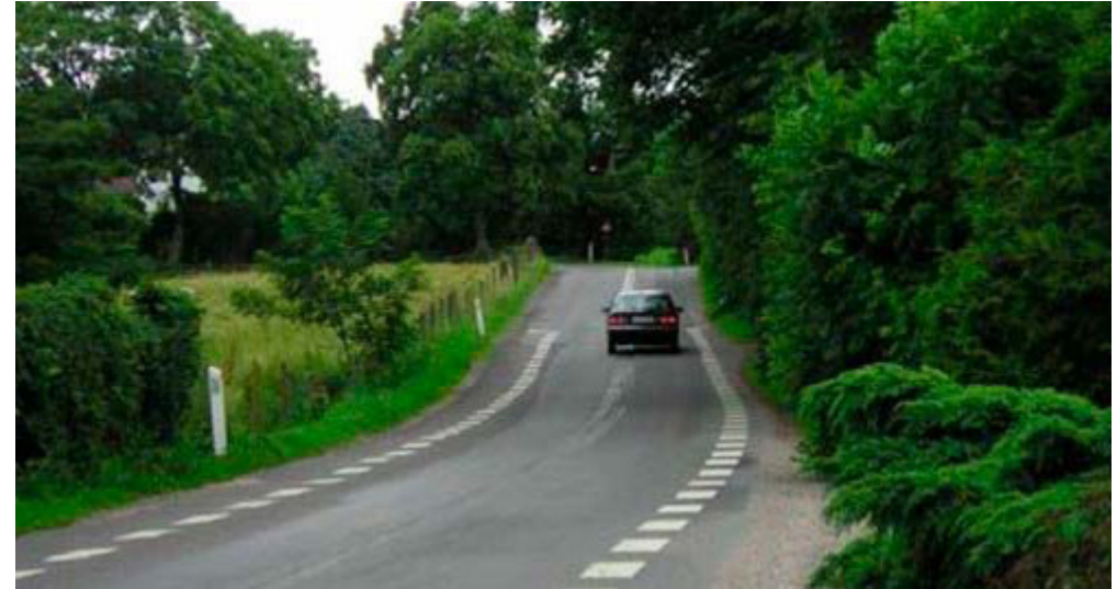
| Fotografía 4.20 Supresión de bandas de protección y recuperación del eje en situación de poca visibilidad
