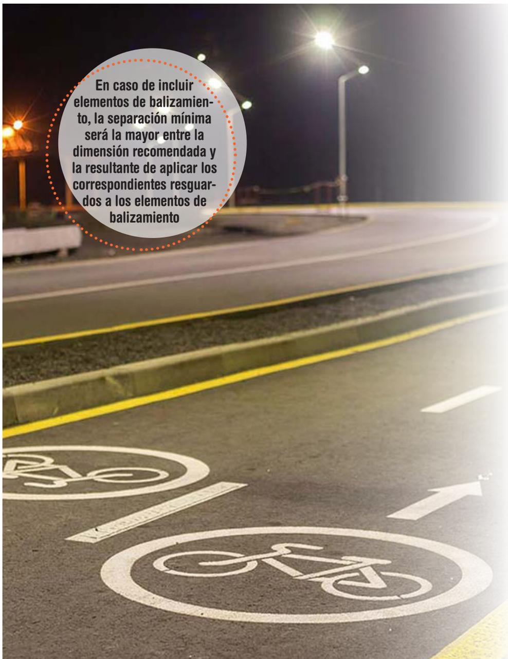
En caso de incluir elementos de balizamiento, la separación mínima será la mayor entre la dimensión recomendada y la resultante de aplicar los correspondientes resguardos a los elementos de balizamiento
