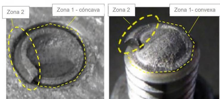
Esta degradación del conjunto generó fatiga en dos de los tres tornillos de esta unión roscada, que acabaron fracturándose, y produciendo la separación de la rueda derecha del tren principal. Se considera factor contribuyente la falta de mención explícita sobre la no reutilización de tuercas autoblocantes en las instrucciones de mantenimiento para el montaje y
