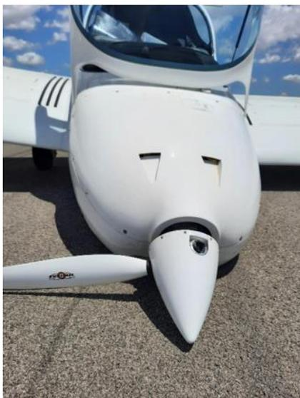
Durante la realización de la maniobra de aterrizaje, tras el contacto con la superficie de pista la aeronave rebotó y se fue de nuevo al aire, contactando de nuevo con la pista con el tren de morro, que colapsó, tocando consecuentemente las palas de la hélice con el suelo. El avión recorrió unos 200 metros hasta detenerse dentro de la pista.
