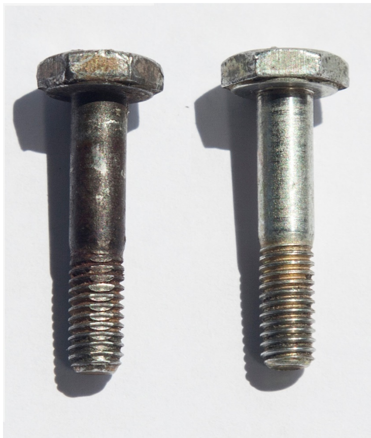
FIG. 4 TORNILLOS DE SUJECIÓN DEL CINTURÓN DE SEGURIDAD, IZQUIERDO (PILOTO), DERECHO (PASAJERO)
