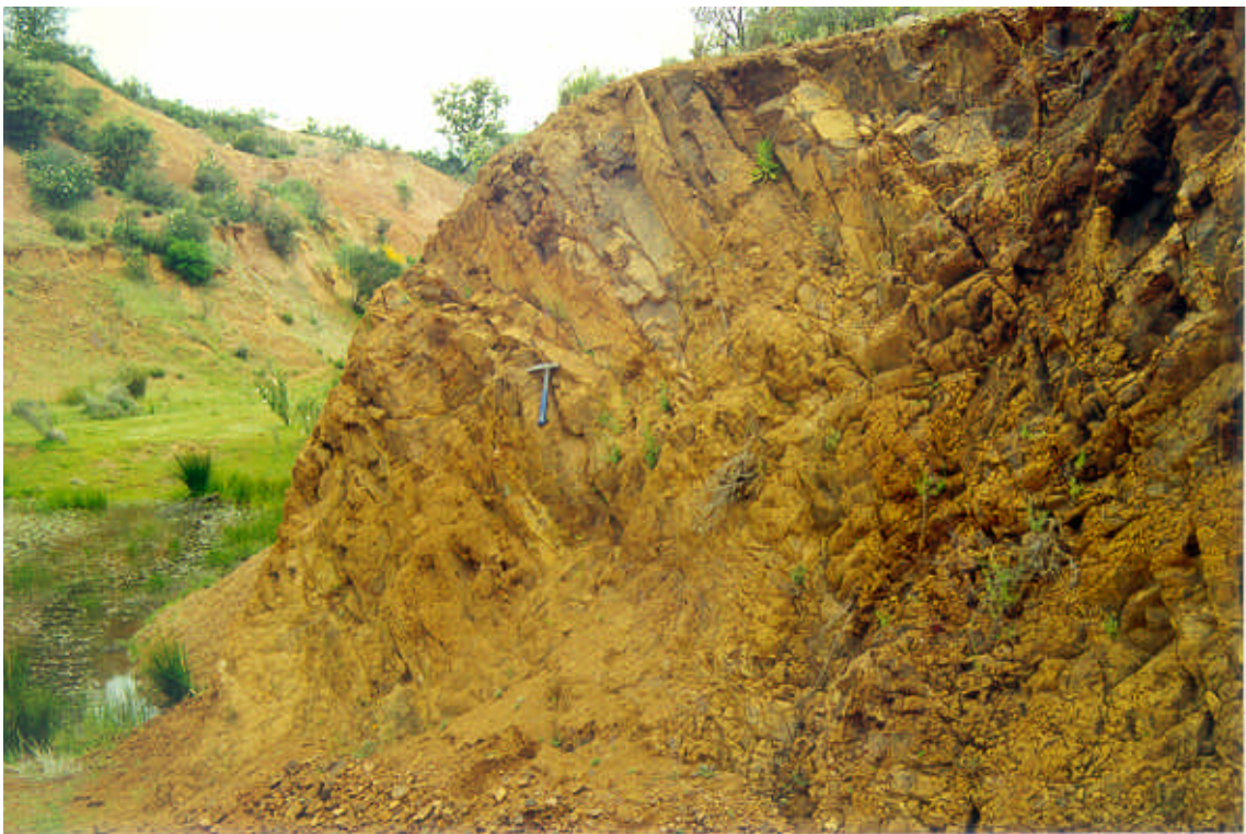
Foto nº 35. Aspecto de las diabasas completamente alteradas que forman el grupo litológico 001. Fábrica de ladrillos situada en el P.K. 12+500 de la carretera comarcal 503.
