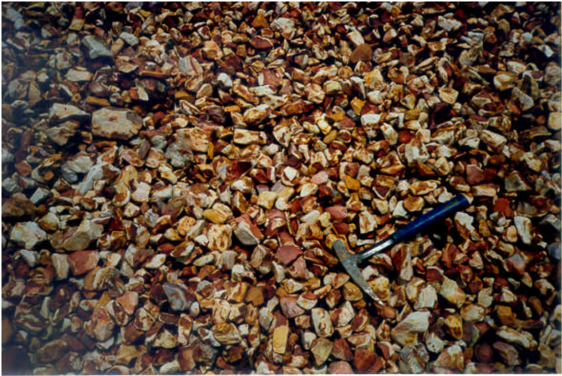
Foto nº 57. Aspecto de las gravas cuarcíticas que forman parte de la Raña, y que son aprovechadas en la explotación YG-1.
