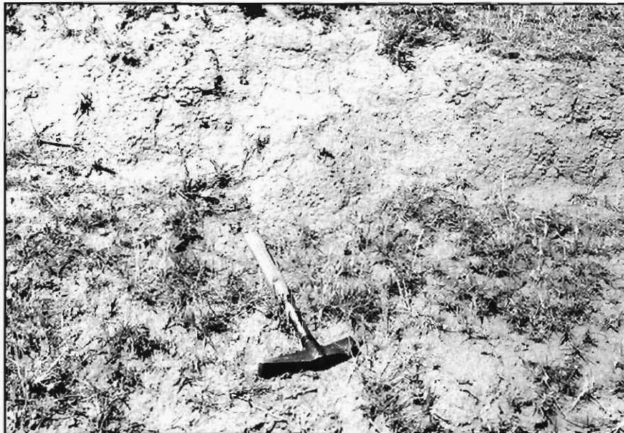
Figura 3.10.- Aspecto de detalle de las arenas limo-arcillosas del grupo C1. Puede apreciarse su fina granulometría y algunos cantos de cuarzo. Proximidades de la localidad de Villoria (Hoja 479-1).
