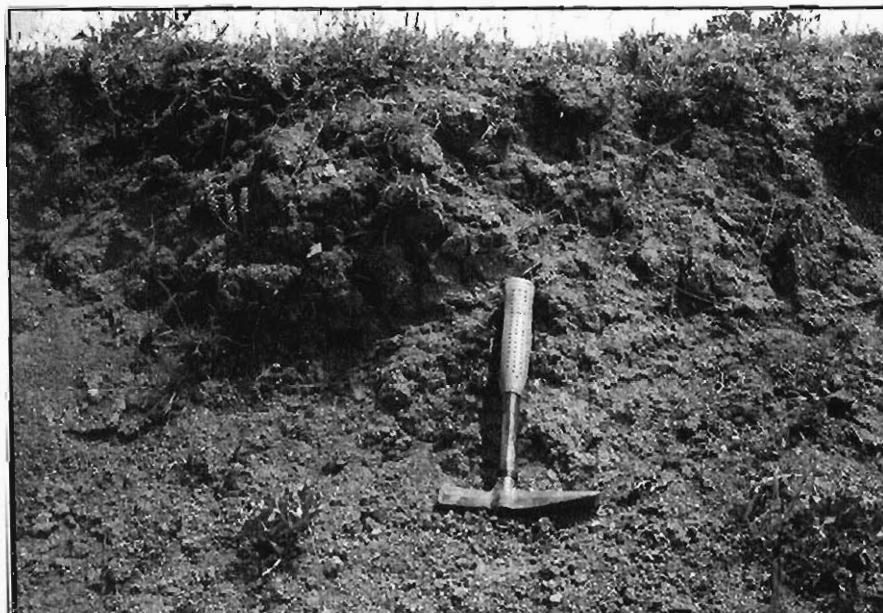
Figura 3.11.- Aspecto parcial y de detalle de las arcillas arenosas del grupo V1, en las proximidades de la localidad de Narros de Saldueña (Hoja 480-2).
