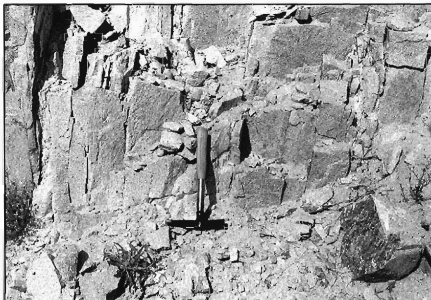
Figura 3.52.- Aspecto del diaclasado de los granitos aplíticos en las proximidades de la localidad de Cardeñosa (Hoja 506-3). Puede apreciarse cómo el diaclasado produce la disgregación de la roca en pequeños bloques tabulares.
