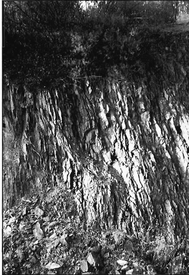
Figura 3.47.- Detalle de las pizarras del grupo (143a), en un desmonte situado en el P.K. 10,300 de la carretera N-433. Tal y como puede apreciarse en la fotografía, estas rocas presentan una esquistosidad muy penetrativa.
