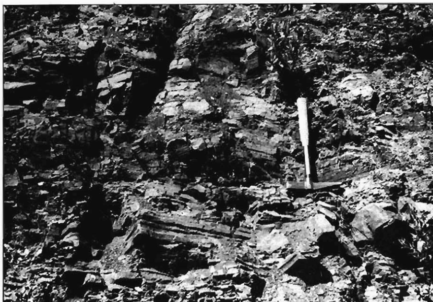
Fig. 3.19.— Detalle de la alternancia irregular de calizas y pizarras, en las inmediaciones de la población de Atalaya.
