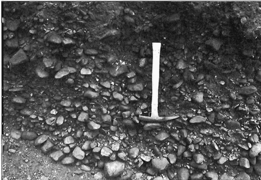
Foto 16.- Grupo T3. Detalle de los materiales de esta terraza. Nótese las distintas granulometrías existentes.
