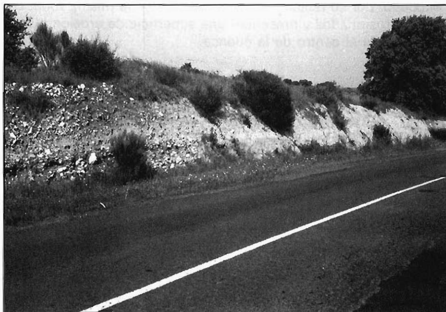
Foto 22.- Arenas y arcillas del grupo (321c) en el P.K. 7,8 de la carretera local de Plasencia a Montehermoso.
