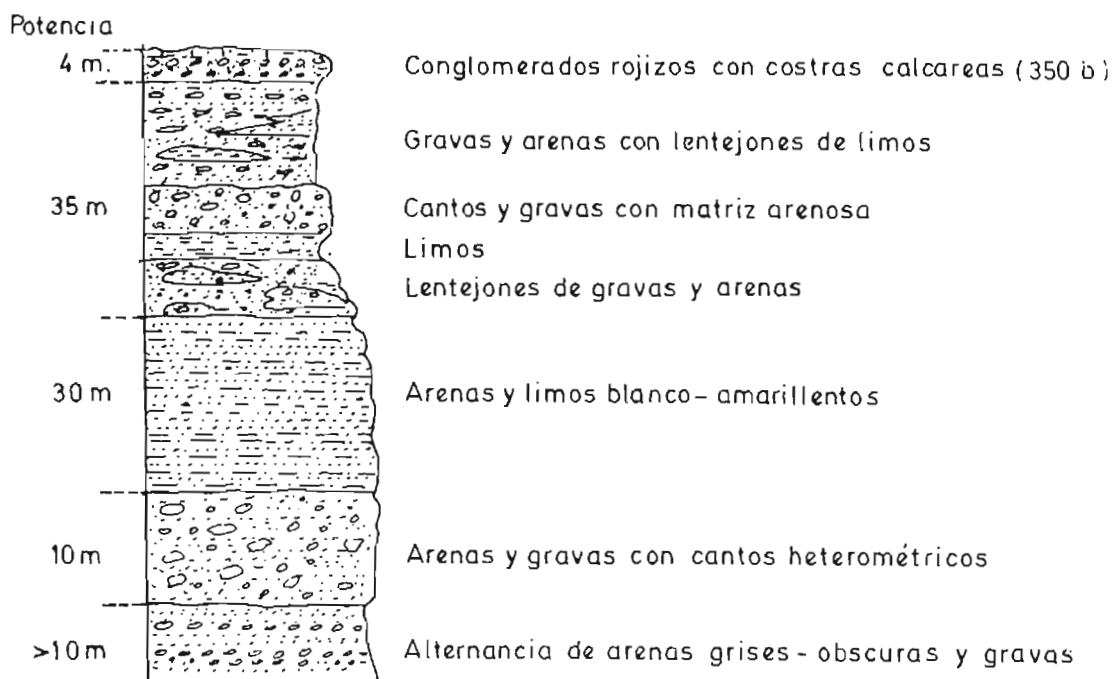
Fig. 12. Corte esquemático del Plioceno (grupo 322b1) en el P. K. 212 de la C. N. 342.
