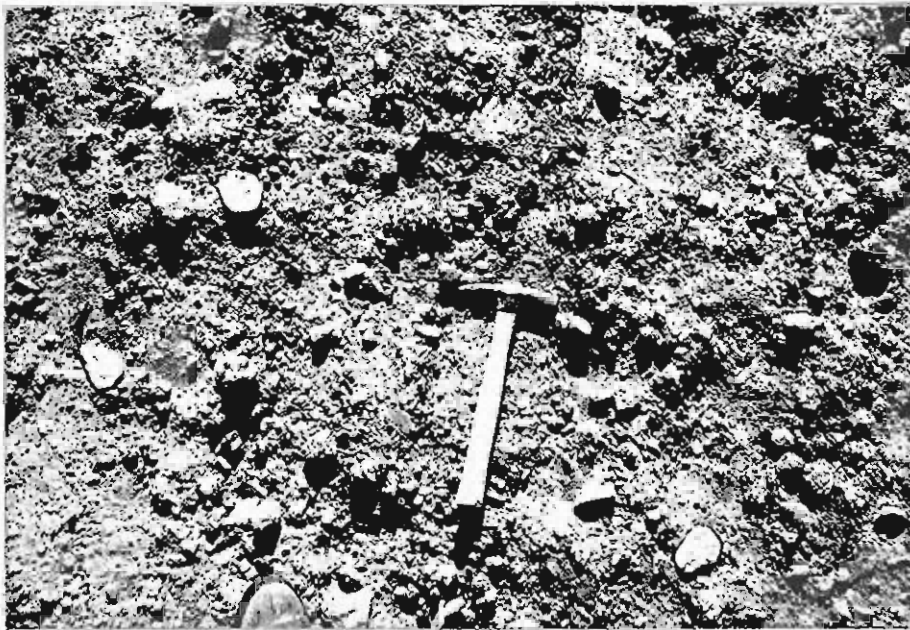
Foto 22.— Detalle de las margas con gravas del Glacis de la Dehesa Nueva (350c). Foto tomada en las proximidades al P.K. 26 de la carretera C-220.
