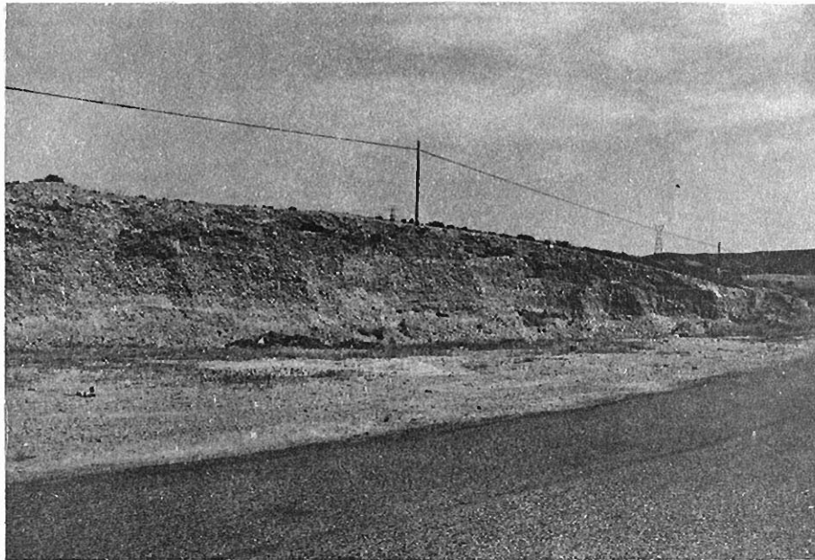
Foto 85.— Yacimiento granular núm. 67. Corte en uno de los lentejones de gravas de la terraza T3, en la margen derecha del río Jalón. Carretera Z-301, P.K. 9.
