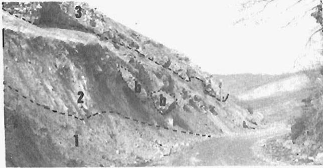
Foto 6.— Materiales de Facies Keuper (1) junto con sus suelos de recubrimiento (2, b = bloques sueltos) y carnioles liásicas suprayacentes (3). (Camino a Fontecha). (Cuadrante 83-3).
