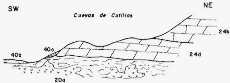
Fig. 41.— Disposición estructural de los materiales triásicos y liásicos, grupos 20a, 20d y 24b en el paraje denominado Cuevas de Cutillas (Cuadrante 892-1).
