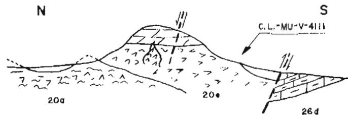
Fig. 27.— Disposición estructural esquemática de los grupos 26d, 20e y 20a al N de las Casicas. (Cuadrante 892-3).
