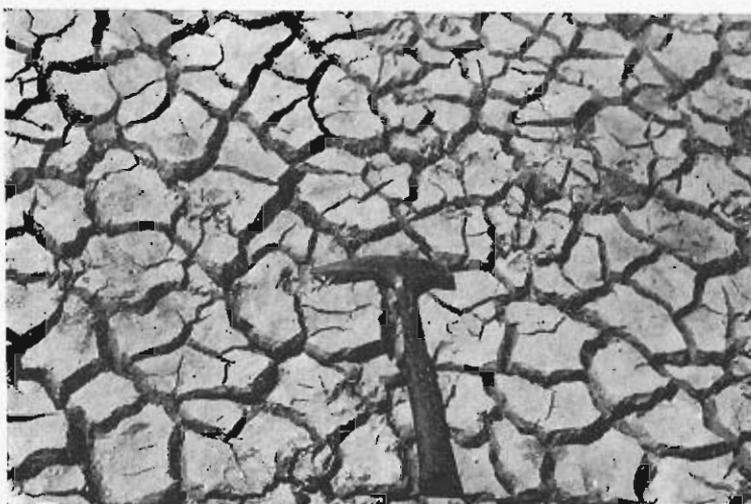
Fig. 47. Suelo arcillo-salino, plástico, de la laguna de Pétrola
