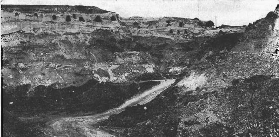
Fig. 37. Cantera para explotación de las arcillas de la base de la facies «Utrillas», en la parte superior se observan las arenas
