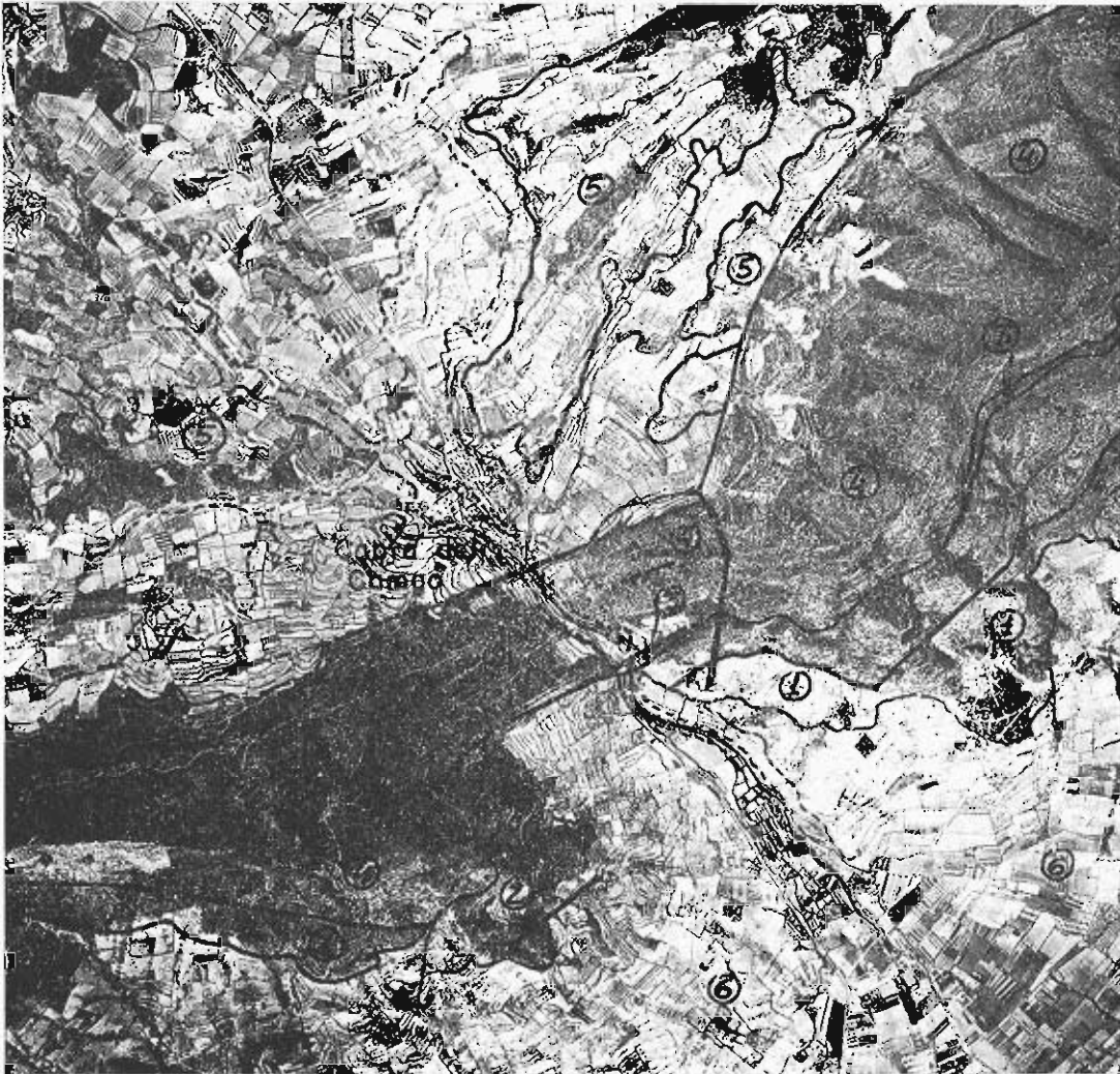
Fig. 50. Foto aérea de la Sierra de Miramar, en Cabra del Campo. 1) pizarras; 2) Muschelkalk; 3) Keuper; 4) Lias; 5) Oligoceno; 6) glaciais
