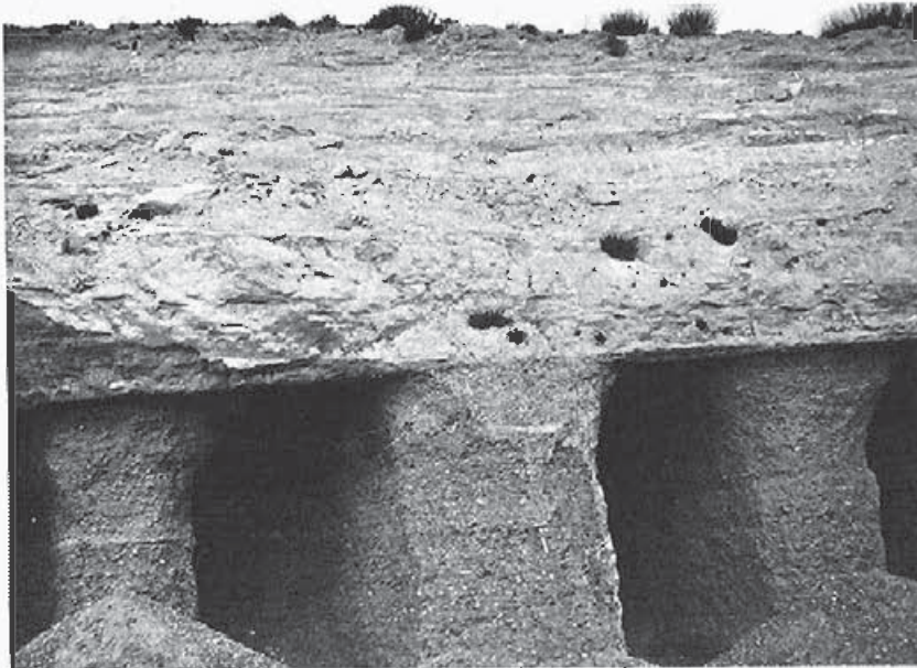
Foto 41.—Detalle de la explotación de gravas y préstamos en el yacimiento E-6, cercano a Osera, por el método de pilares abandonados — 39a.
