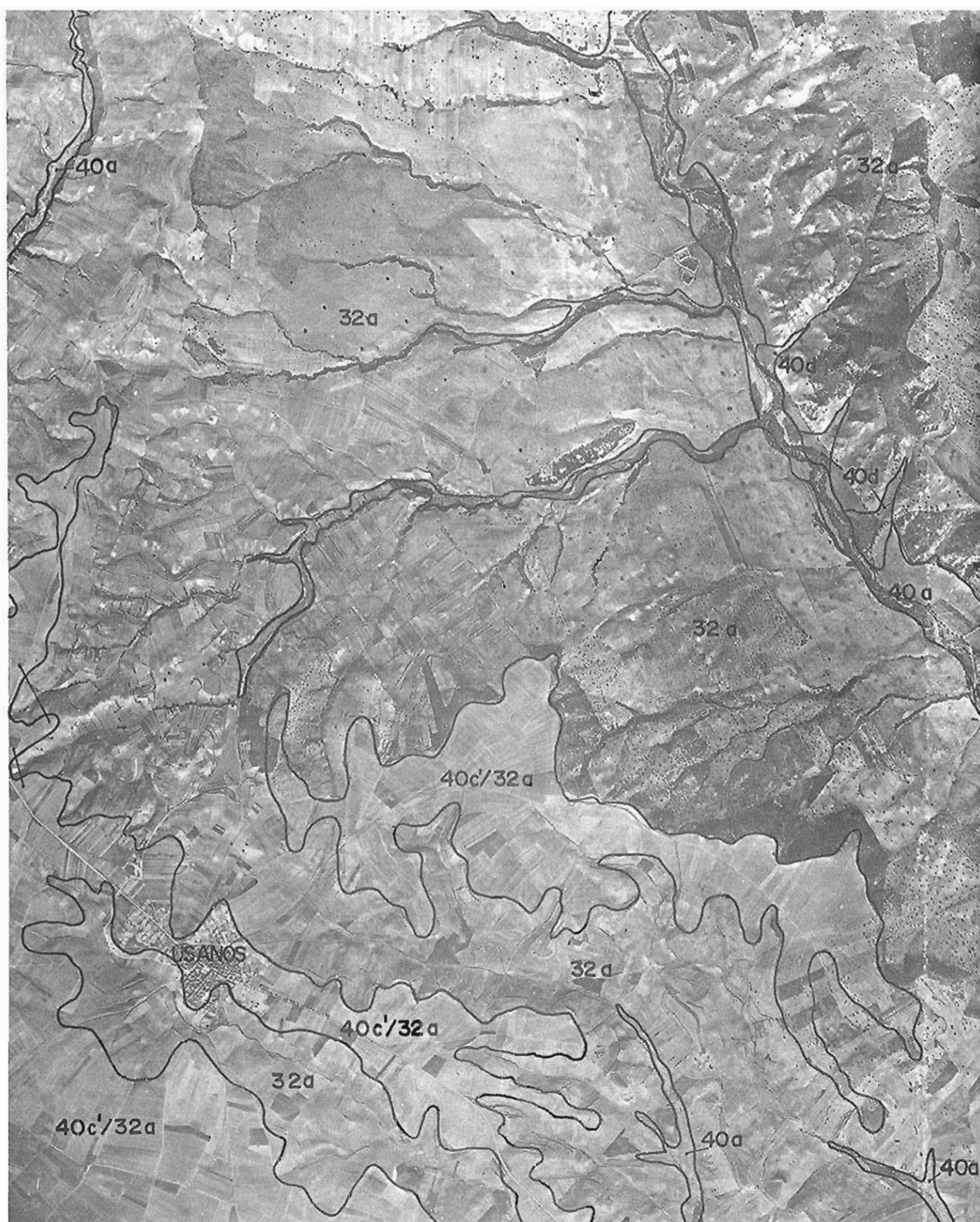
Foto 1.— Vista aérea vertical del extremo nororiental de la zona I. Arroyo de las Dueñas con su densa red de cauces afluentes, de talwegs angostos y prácticamente carentes de depósitos aluviales, expresión topográfica de un substrato granular bastante homogéneo, y poco consolidado en general.
