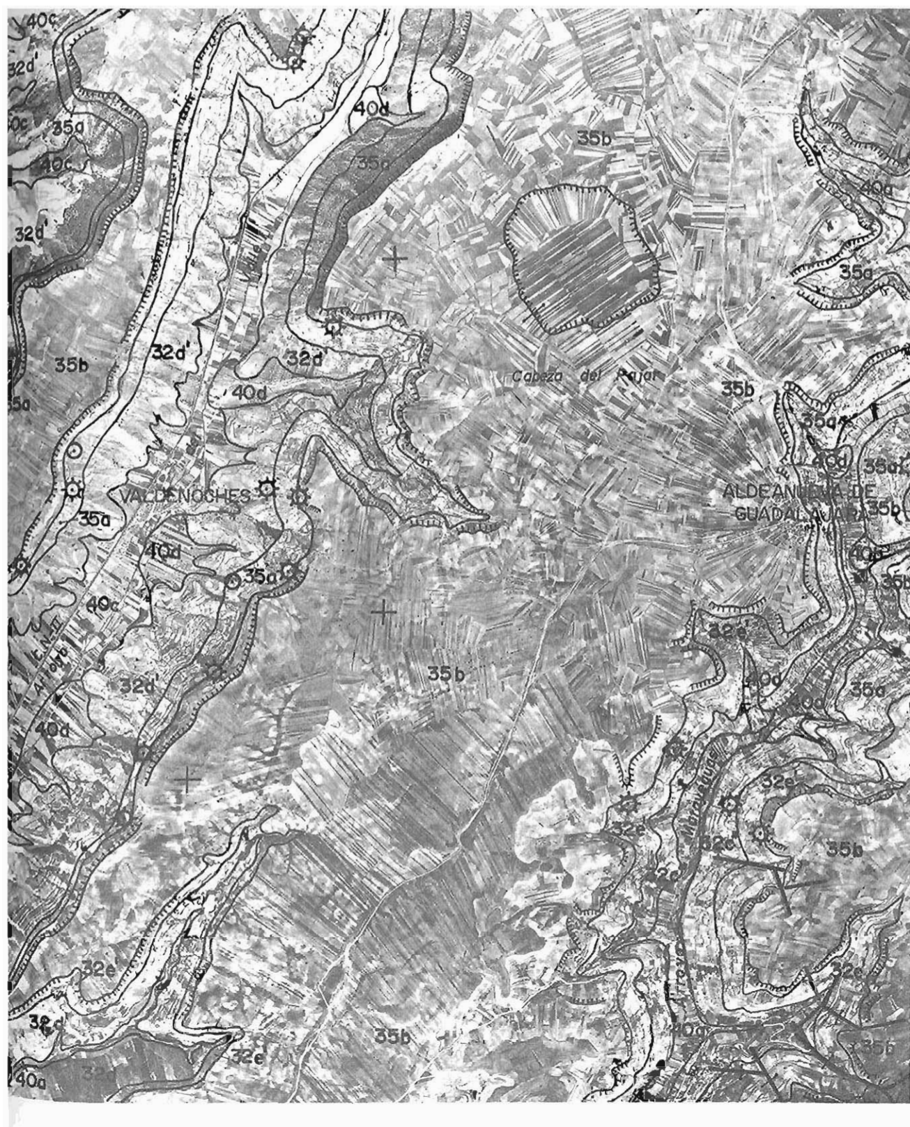
Foto 31.— Mesas de la Alcarria con fuertes escarpes en los valles interiores. En éstos, las laderas son inestables con frecuentes deslizamientos ( ⊗ ) y desprendimientos de bloques ( ⊙ ). (Hoja 511-3).
