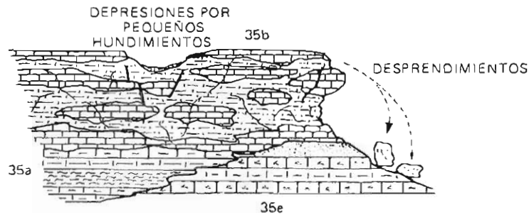
Fig. 22.— Corte esquemático y principales problemas geotécnicos del grupo 35b. 35b: calizas y margas; 35a: calizas margosas, margas y arcillas; 35e: margas yesíferas y yesos.
