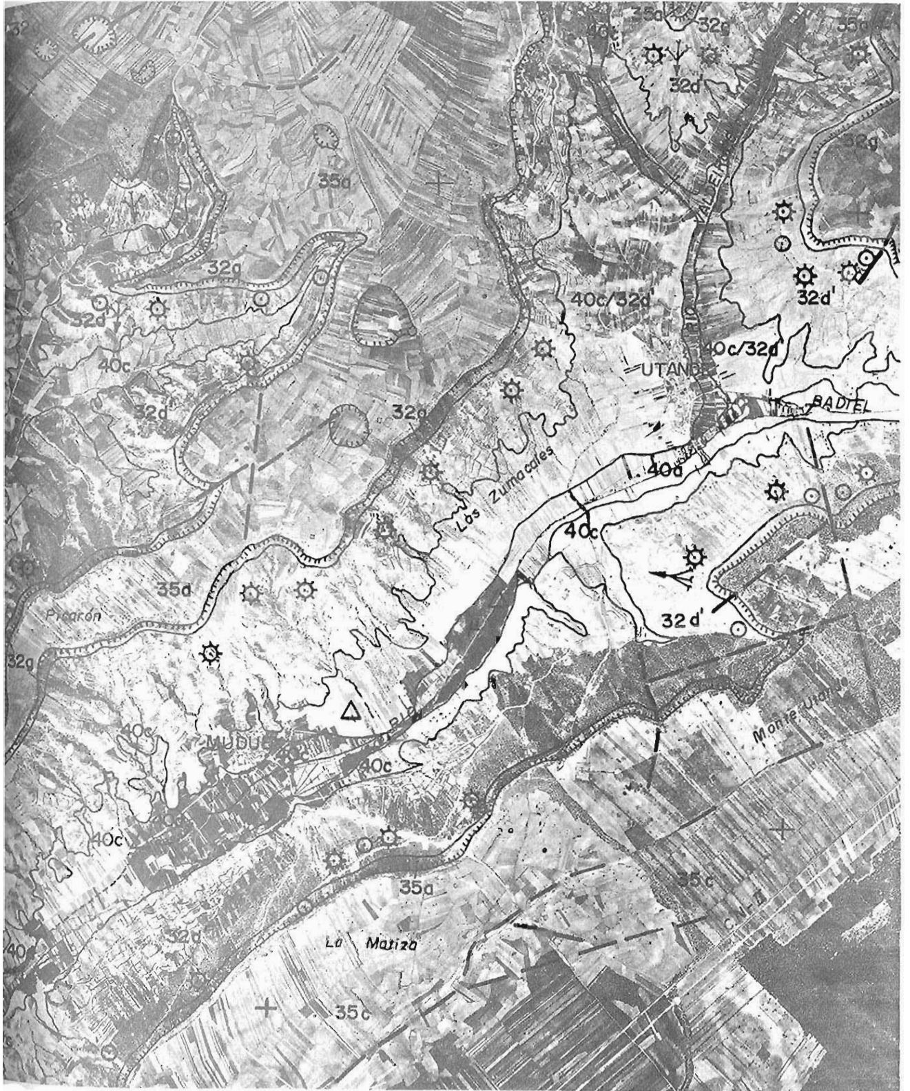
Foto 35.— Valle del Badiel encajado en la mesa, con laderas altamente inestables: desprendimientos (⊙), deslizamientos (⚙) y acaravamientos (↘). El fondo presenta problemas de mal drenaje (μ) y aterramientos (⊖) de vías de comunicación (Hojas 486-2 y 511-1).
