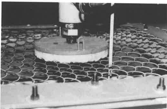
Foto 7.3. Detalle de la placa de aplicación de la carga y de la sujeción perimetral
