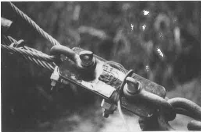
Foto 7.19. Colocación de las bandas extensométricas en el cable
