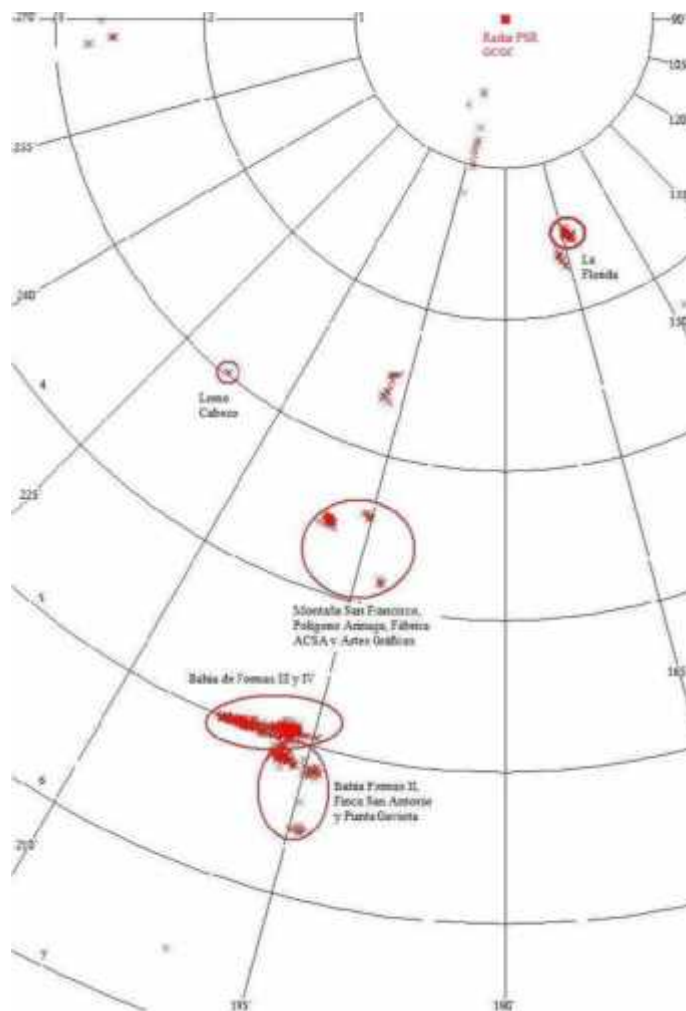
Figura 9. Blancos falsos producidos por aerogeneradores en el radar de Gran Canaria.
