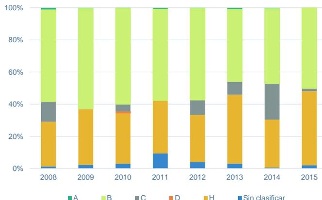
En un segundo plano se encontrarían las aeronaves tipo C, que en 2014 registraron su máximo histórico de movimientos en la instalación debido a la elevada utilización que la compañía Aeronova realizó del modelo ATR 42.
