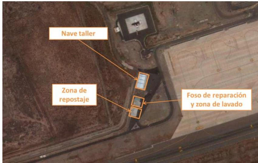
Ilustración 2.21.- Zonas de estacionamiento de vehículos handling (EPA)
