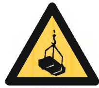
PELIGRO CARGAS SUSPENDIDAS
