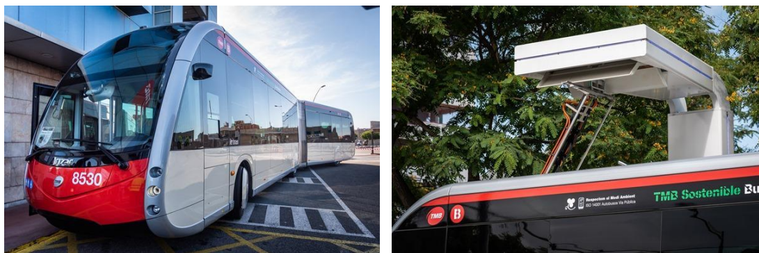
Figura 11. Autobuses eléctricos articulados con sistema de recarga en terminal
