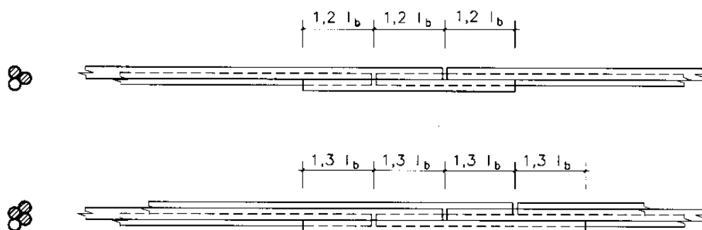
Figura 49.5.2.3 Empalmes por solapamiento de grupos de barras
