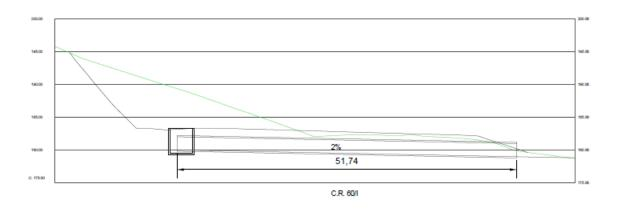
Ramal 1.3- Se diseña una ODT consistente en un tubo de hormigón de 2000 mm con una clase resistente 60. La longitud de esta ODT es de aproximadamente 34 m con una pendiente longitudinal del 2% y una arqueta que recibe el caudal correspondiente al ramal en cuestión.
