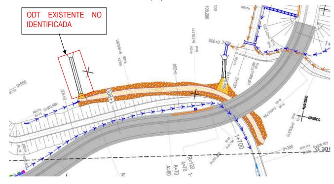
Dicha obra de drenaje longitudinal está comprendida entre la antigua línea de ferrocarril Pontevedra-Redondela y la reposición del camino LAV 502+620 y se dimensiona para el caudal de la cuenca de proyecto C 25\_D y los flujos procedentes de las cunetas del margen derecho del Ramal 2.7. tal y como muestra la siguiente imagen.
