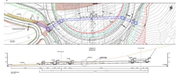
La ODT 0.01 canaliza todas las aguas provenientes de las cuencas de proyecto 1\_I, 2\_I, 3\_I y 4\_I así como todas las obras de drenaje longitudinal existente desde el PK 0+000 al 1+160 que se conducen a través del ramal 1.2 y 1.3 hasta la ODT en cuestión
