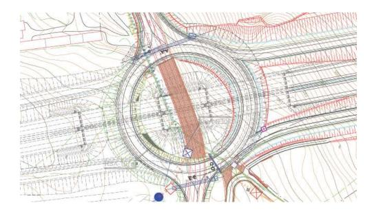
Tal y como muestra la imagen anterior las ODTs planteadas desalojan el agua en zonas con una adecuada evacuación del agua, considerando en todo momento el trazado del siguiente tramo de la Autovía A-57 (Tramo Pilarteiros – A Ermida).
