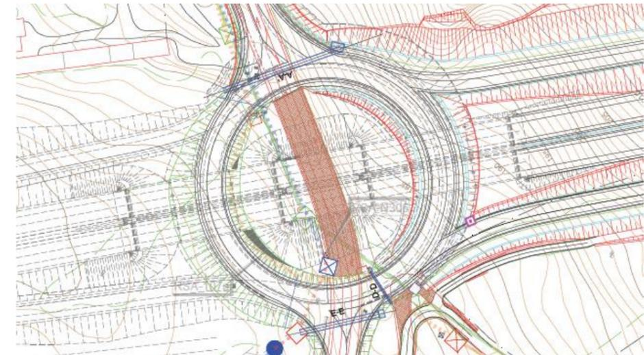
Tal y como muestra la imagen anterior las ODTs planteadas, desalojan el agua en zonas con una adecuada evacuación del agua, considerando en todo momento el trazado del siguiente tramo de la Autovía A-57 (Tramo Pilarteiros – A Ermida).
